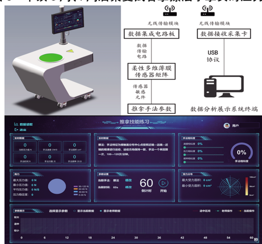
图2 推拿手法数据采集器及其原理示意图
